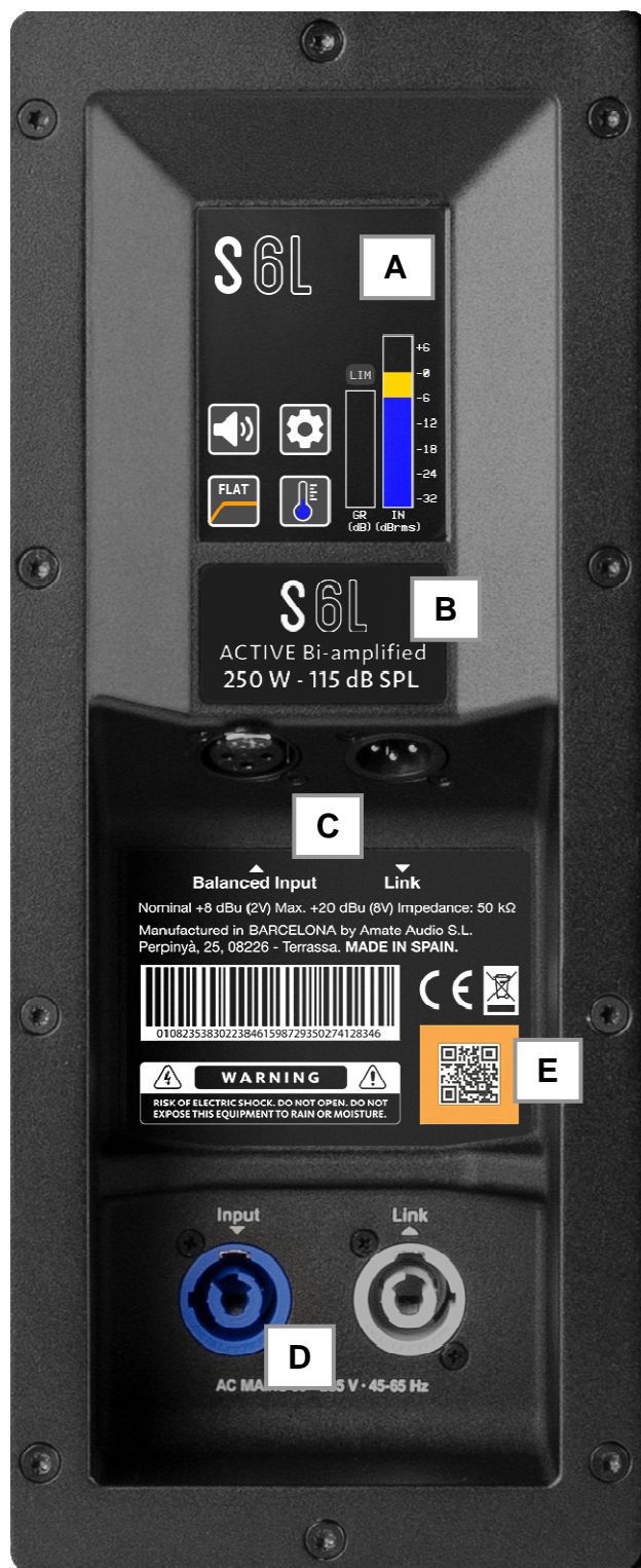
Fig. 2. Panel de control y conexiones de la S6L
