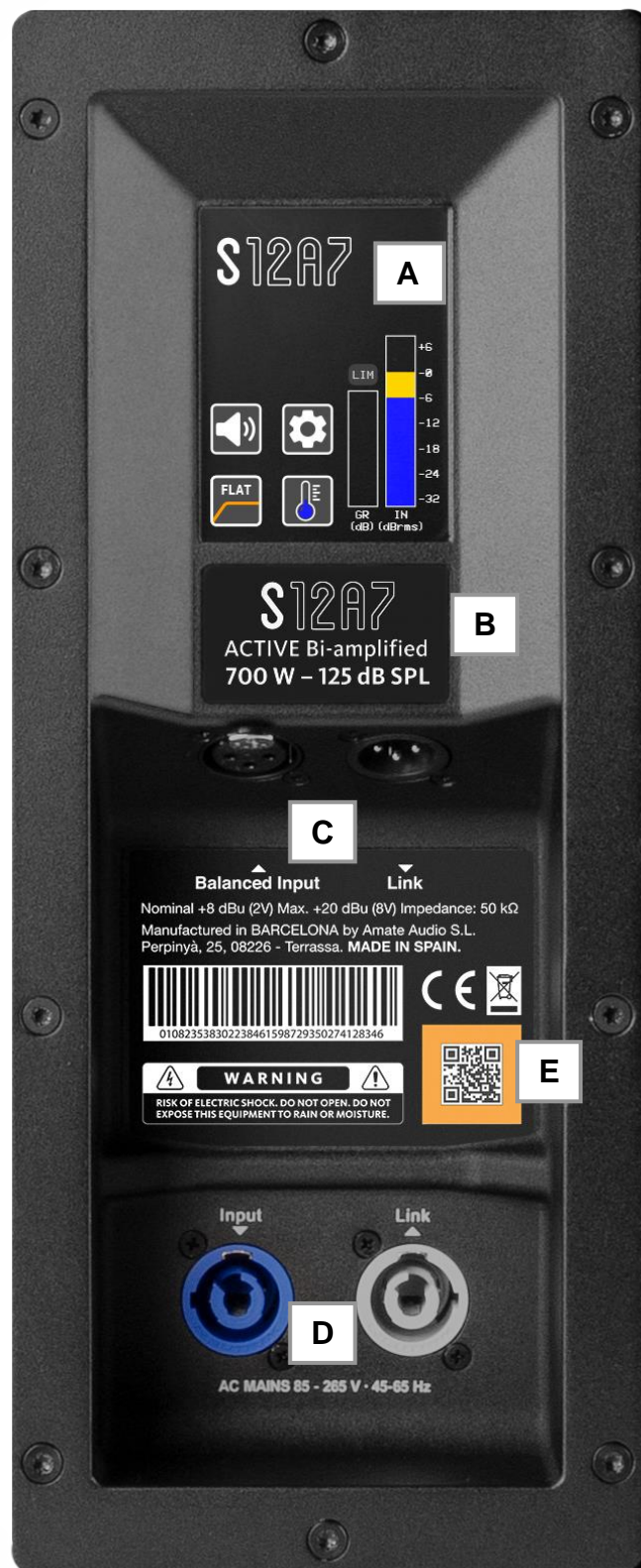
Fig. 2. Panel de control y conexiones de la S12A7
