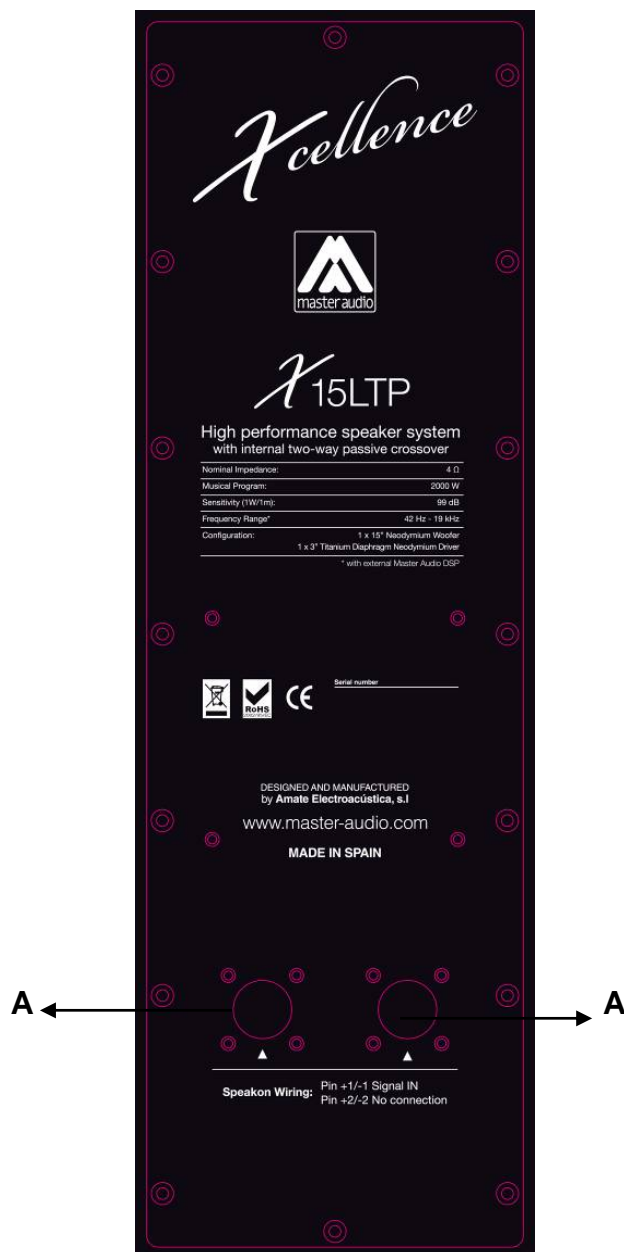
Fig.11. Panel de conexiones X15LTP
