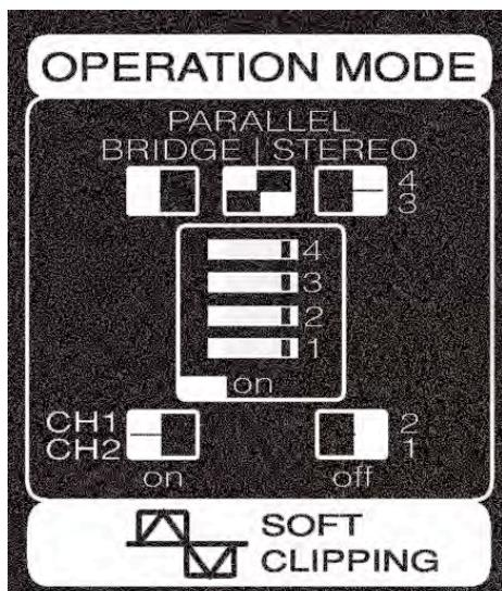
Para su utilización en modo MONO, debe colocarse el conmutador MODE, DIP switch 3 y 4 en posición ON. En esta circunstancia se iluminará el indicador correspondiente situado en el panel frontal sobre el control del Canal A (BRIDGE). La ganancia se controlará únicamente mediante el potenciómetro del canal A.
