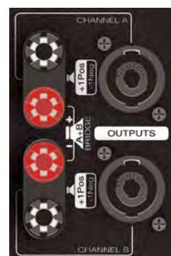
Se dispone de dos salidas para altavoces. Canal A y Canal B, provistas de una base para conector Speakon, y un par de Bornes para cada una.
